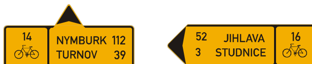
Dopravní značka č. IS 19b a č. IS 19d "Směrová tabule pro cyklisty (se dvěma cíli)"
